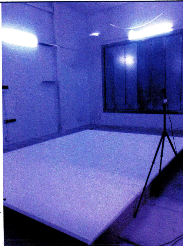
Fotografía N°1: Vista de la muestra montada en cámara reverberante para ensayo de absorción.
